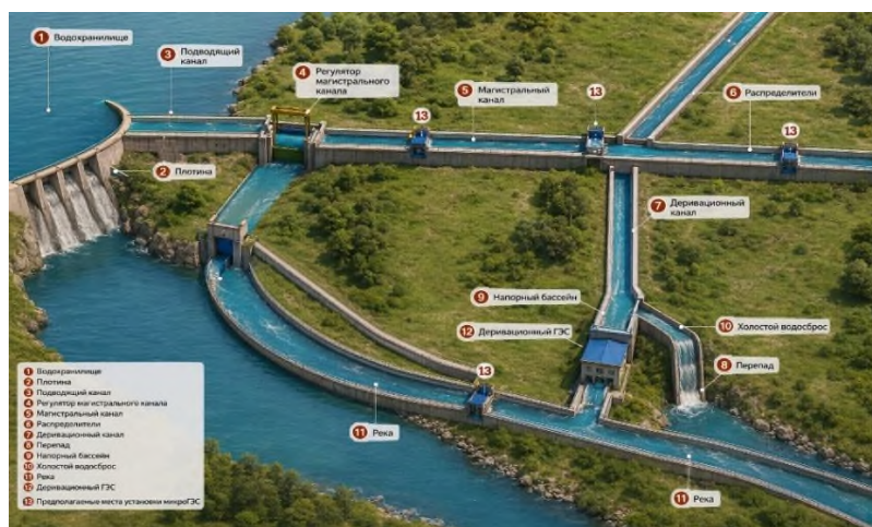
Рисунок 1 - Схема гидроузла энергосистемы и предполагаемые места установки микроГЭС. (Сгенерировано ИИ).
